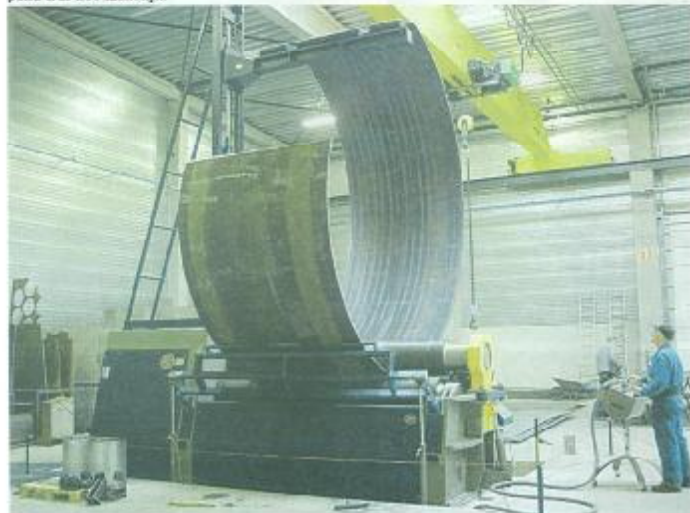
De derde machine die is aangekocht, is een zware plaatwals die platen kan centeren tot 40 mm dikte en een lengte van 3.000 millimeter.
