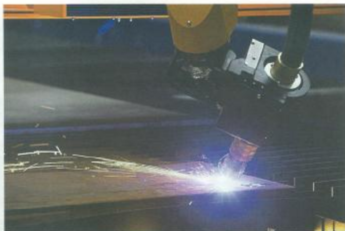
Het is de eerste plasmasnijder van Microstep die bodems kan snijden met een eindeloos roterende 3D-kop.
